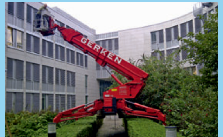
Der Hecke wird durch die spinnenartige Abstützung kein Blättchen gekrümmt: Die GSA 30 G bietet viel Reichweite ohne Umsetzen, die kompakten Abmessungen ermöglichen auch Einsätze hinter engen Durchfahrten.
